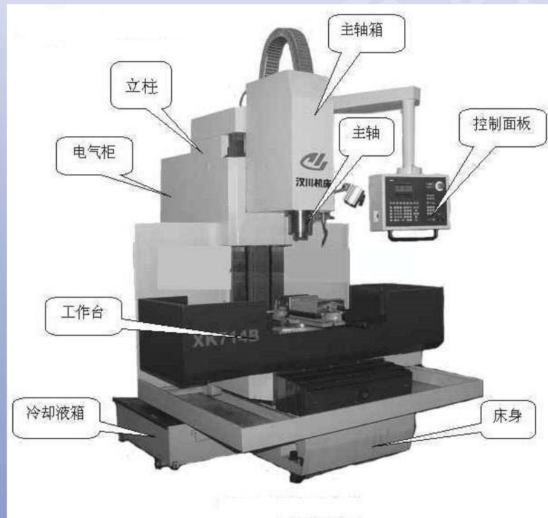
数控铣床的结构图
