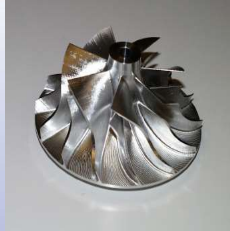
(2) 整体叶轮类 加工难点，通道狭窄，刀具很容易与加工表面和邻近曲面产生干涉
