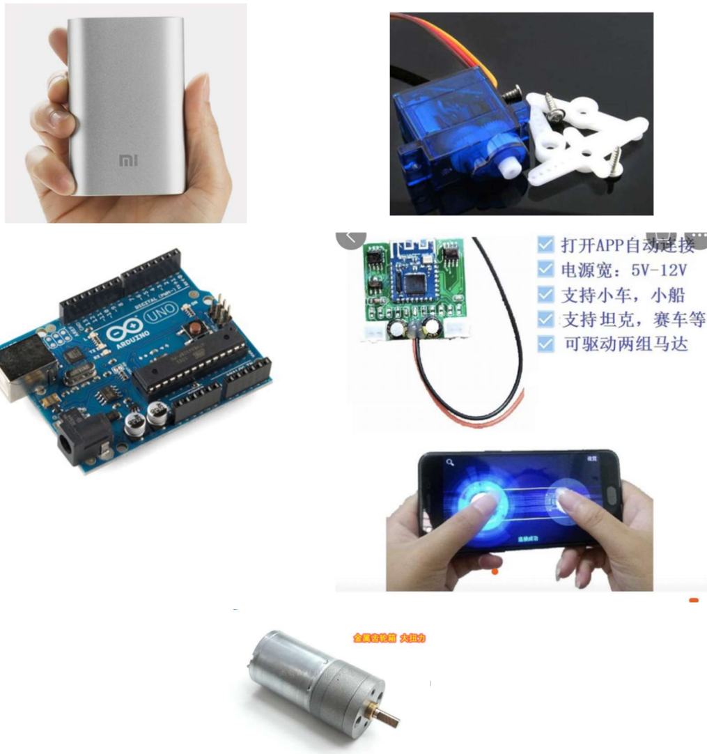
图2 电源、舵机、Arduino、蓝牙开发板、直流减速电机
