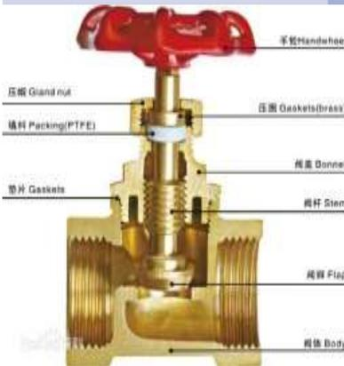
阀门：是用来开闭管路、控制流向、调节和控制输送介质的参数（温度、压力和流量）的管路附件。根据其功能，可分为截止阀、止回阀、调节阀等。
